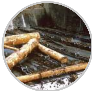
Egyedi szállítólánc farönkökállítására, szállítási teljesítmény:1200 tonna/nap.
