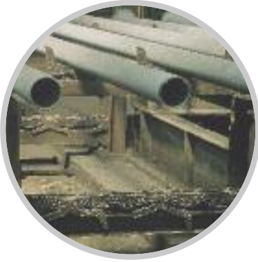
Párhuzamosan futó, öntött-vascsöveket szállító lánc.
