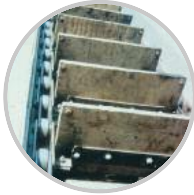
Szállítólánc egyedi kaparó elemekkel szerelve.
