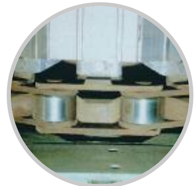
Szállítólánc, alumínium csatlakozó lemezekkel szerelve, gumós növényekállítására.
